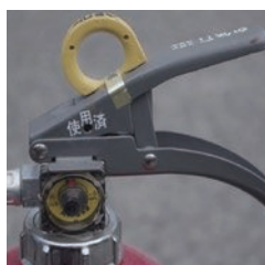
× 表示装置の脱落
