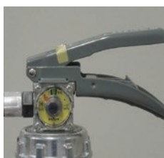
× 安全栓の脱落
