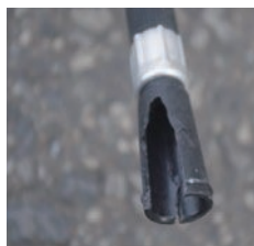
× ノズルの破損
